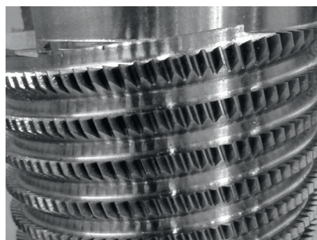
Werkstück mit verdrehter Spannutt
